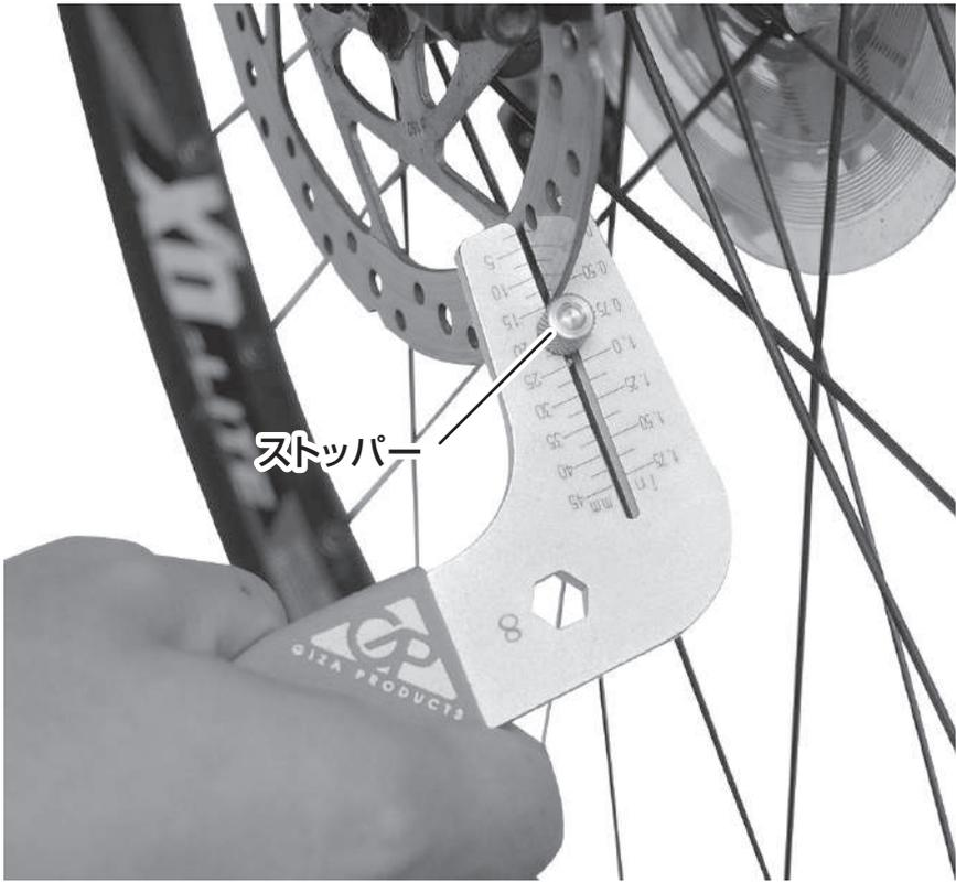
ストッパーの位置を調節し、ディスクローターに差し込んで矯正します。
